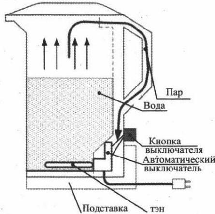
Постепенно вода прогревается, закипает, над бурлящей водой поднимается пар. Горячий пар проходит через небольшое отверстие и попадает на биметаллическую пластину. Один из металлов пластины при нагреве паром расширяется сильнее, пластина изгибается и размыкает цепь. Процесс нагрева завершён, можно заваривать чай.
